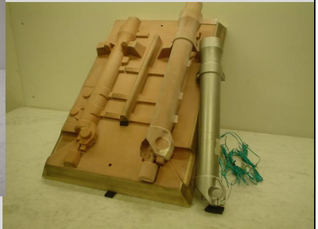
Modello da fonderia per gambale sospensione anteriore
